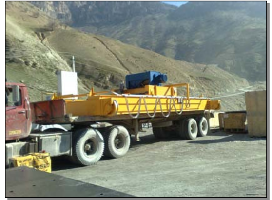
جرثقیل سقفی ۴۰ تنی با دهانه ۹.۵ متر کارون ۴
